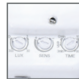
regulacja czujnika LUX / SENS / TIME
