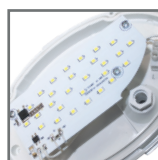
źródła światła LED ze zintegrowanym zasilaczem
